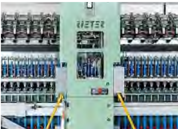
Figura 10: Robô de emenda. Fonte: Rieter
