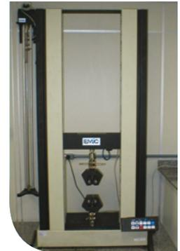
Dinamômetro usado para ensaios de resistência à tração
