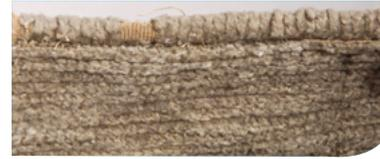
Tecido desgastado pelo uso de cordão em posição inadequada. A modelagem, a costura mal posicionada, a combinação com aviamentos etc podem gerar um desgaste acelerado pela abrasão em determinadas partes do estofado.
